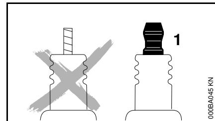
У свечи зажигания с отдельной соединительной гайкой
