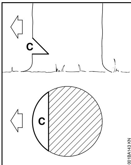
**C** = Подпил определяет направление валки дерева.
