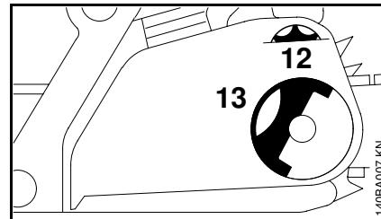
При насаживании крышки цепной звездочки зубья натяжного колеса и натяжного диска должны входить в зацепление с друг другом, при необходимости,
