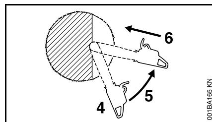
**4 = Направляющую шину устанавливайте нижней, а не верхней стороной головки. – Опасность отдачи!**
