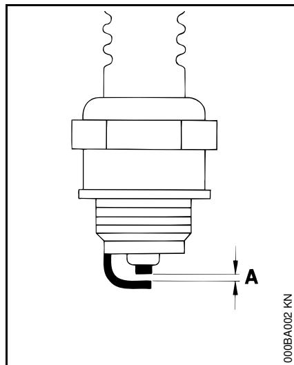
При недостаточной мощности двигателя, при плохом запуске или перебоях на холостом ходу в первую очередь следует проверить состояние свечи зажигания.
