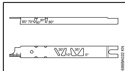
пользуйтесь опиловочным калибром\* фирмы STIHL (специальные принадлежности, см. таблицу "Заточной инструмент"), – универсальный инструмент для контроля угла заточки и переднего угла, высоты ограничителя глубины, длины зуба, глубины паза и для очистки пазов и впускных масляных отверстий.
