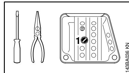
При падении мощности двигателя контролировать искрозащитную решетку\* в глушителе отработавших газов.
