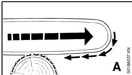
Если при пилении нижней стороной направляющей шины – передний рез – пильная цепь защемляется или наталкивается на твердый предмет в древесине, то пила может быть затянута рывком в сторону ствола, – **поэтому всегда устанавливайте надежно зубчатый упор!**
